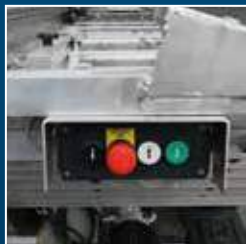
Elektrische Steuerung mit Schleichgang (optional)
