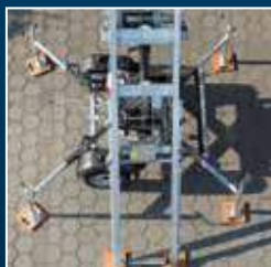
Aufstellfläche von nur 4,6 m 2 ermöglicht den Einsatz auf engstem Raum
