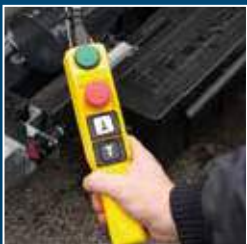
Elektrische Steuerung mit Schleichgang (optional)
